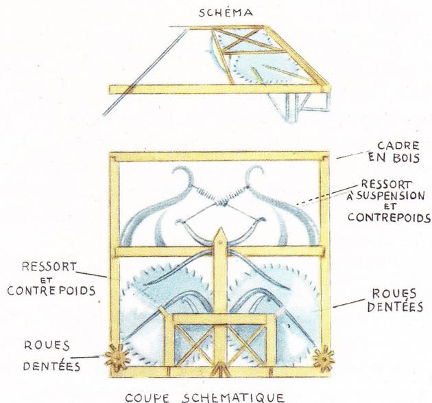
*Schéma du mécanisme de Léonard de Vinci (tiré du Codice Atlantico) : dans ce croquis, on a déjà une idée exacte du véhicule pourvu du différentiel, de la transmission, du dispositif articulé qui deviendra le cardan, des changements de vitesse, ainsi que des petites sphères et des rouleaux destinés à réduire le frottement.*
